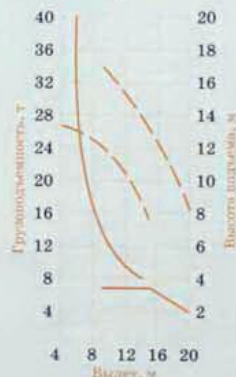
ВЗАИМОСВЯЗЬ ГРУЗОПОДЪЕМНОСТИ, ВЫЛЕТА СТРЕЛЫ И ВЫСОТЫ ПОДЪЕМНОГО КРЮКА ГУСЕНИЧНОГО КРАНА ДЛЯ СТРЕЛЫ ДЛИНОЙ 15,8 м
