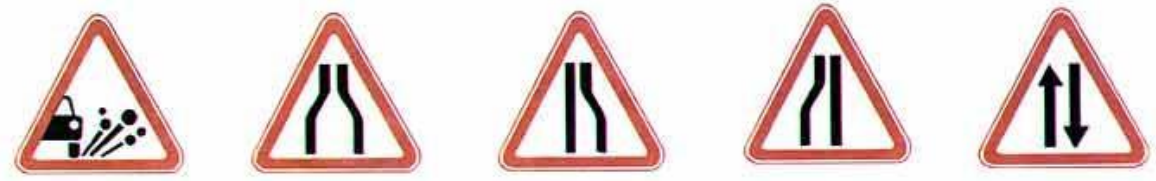
1.17 Выброс гравия 1.18.1 Сужение дороги 1.18.2 Сужение дороги 1.18.3 Сужение дороги 1.19 Двустороннее движение
