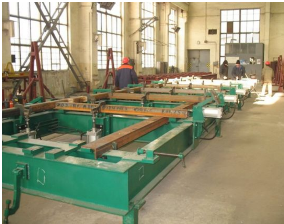
Стенд сборки и сварки каркаса боковой стенки грузового вагона
