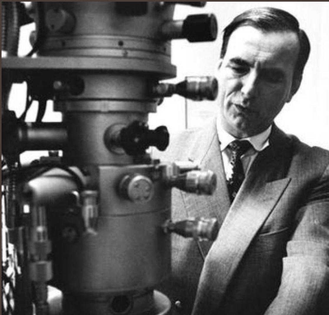
Разработанный в 1939 году Владимиром Зворыкиным прибор давал в 50 раз больше деталей, чем любой из когда-либо изготовленных оптических микроскопов при увеличении до 2 миллионов раз.
