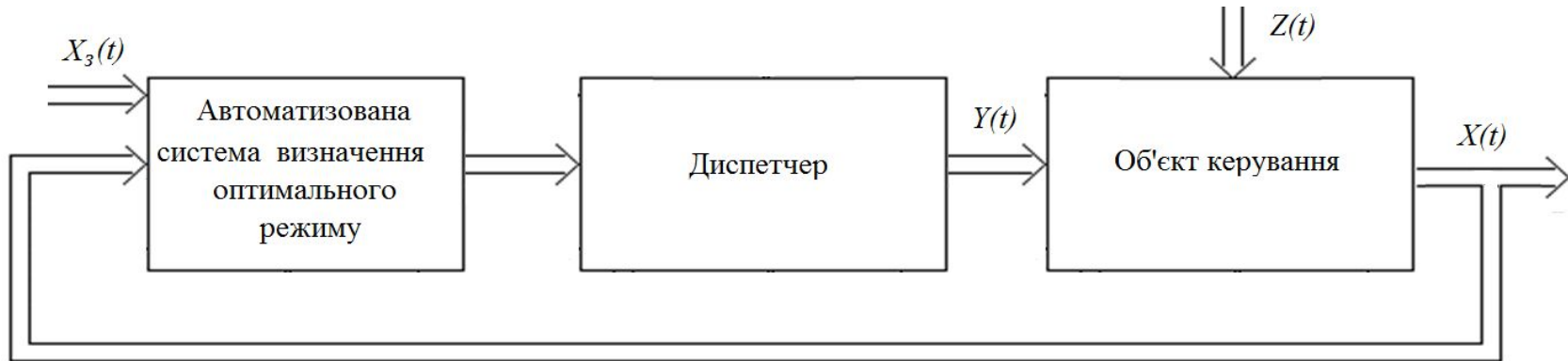
Рис. 18 - Структура енергоефективної системи керування
