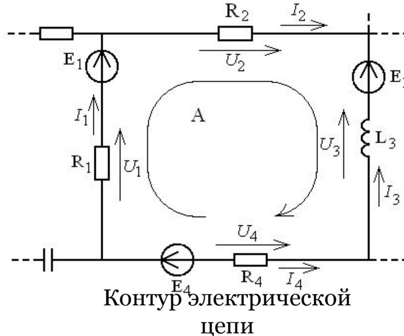
Для этого контура уравнение по второму закону Кирхгофа записывается в виде:
