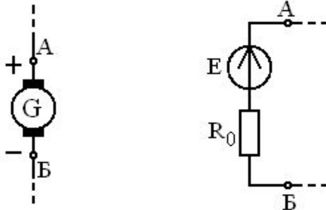
Схема замещения генератора постоянного тока
