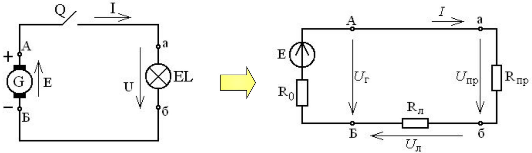
Схема замещения простой электрической цепи
