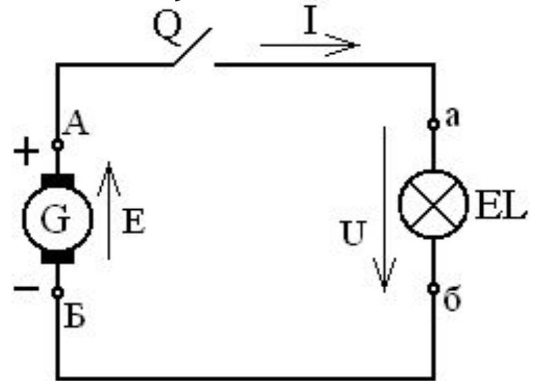
Схема простой электрической цепи
