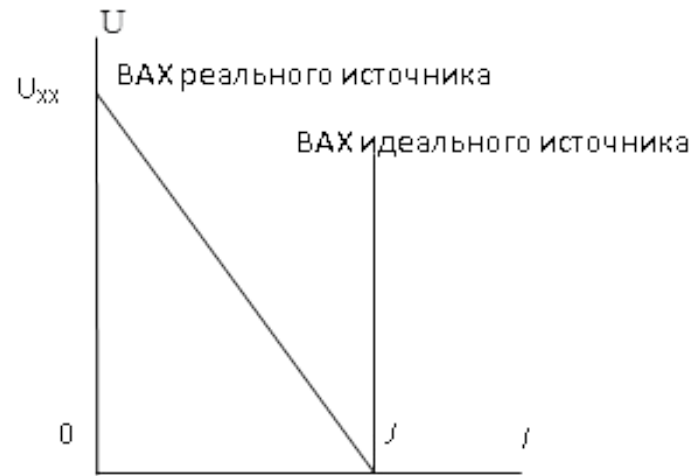
Рис. 2.2. Эквивалентная схема реального источника тока - (а), и его вольтамперная характеристика (ВАХ) - (б).
