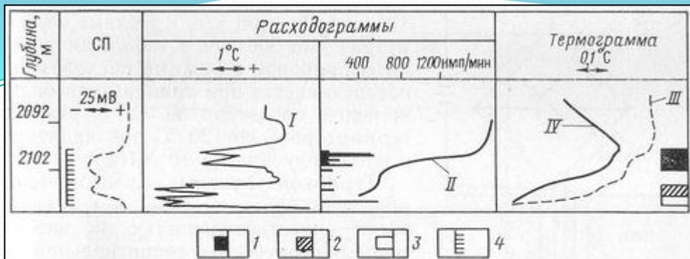
Рис. 174. Выделение работающих интервалов пласта и определение типа флюидов по данным механического и термокондуктивного расходомеров и высокочувствительной термометрии.
