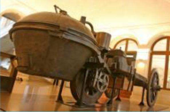
Повозка была грубой формы и предназначалась по замыслу ее создателя для перевозки артиллерии. У нее имелось три колеса, из которых одно впереди, ведущее и одновременно рулевое. Только вода и топливо, необходимые для движения, весили целую тонну.
