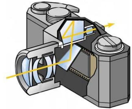
Принцип работы цифровой камеры аналогичен принципу работы фотоаппарата: оптическая система проецирует уменьшенное изображение на матрицу из светочувствительных элементов ПЗС (CCD) или КМОП (CMOS). Далее оцифрованное изображение сжимается в формат JPEG, FlashPix или аналогичный им и затем записывается в память камеры, емкостью которой и определяется количество снимков. Для передачи в ПК записанного в памяти камеры изображения могут использоваться различные носители и интерфейсы.
