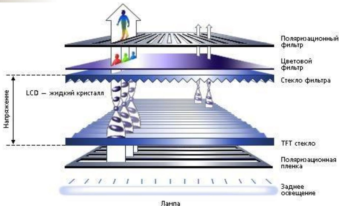
**Управление светом лампы подсветки, проходящим через слой жидких кристаллов за счёт изменения ими плоскости поляризации.**
