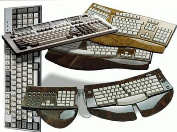
**Принцип действия:** совокупность механических датчиков, воспринимающих давление на клавиши и замыкающих определенную электрическую цепь. Внутри корпуса любой клавиатуры, помимо датчиков клавиш, расположены электронные схемы дешифрации и микроконтроллер клавиатуры. Механическое нажатие клавиши преобразуется в так называемый скэн-код, который передается в контроллер клавиатуры на материнской плате.
