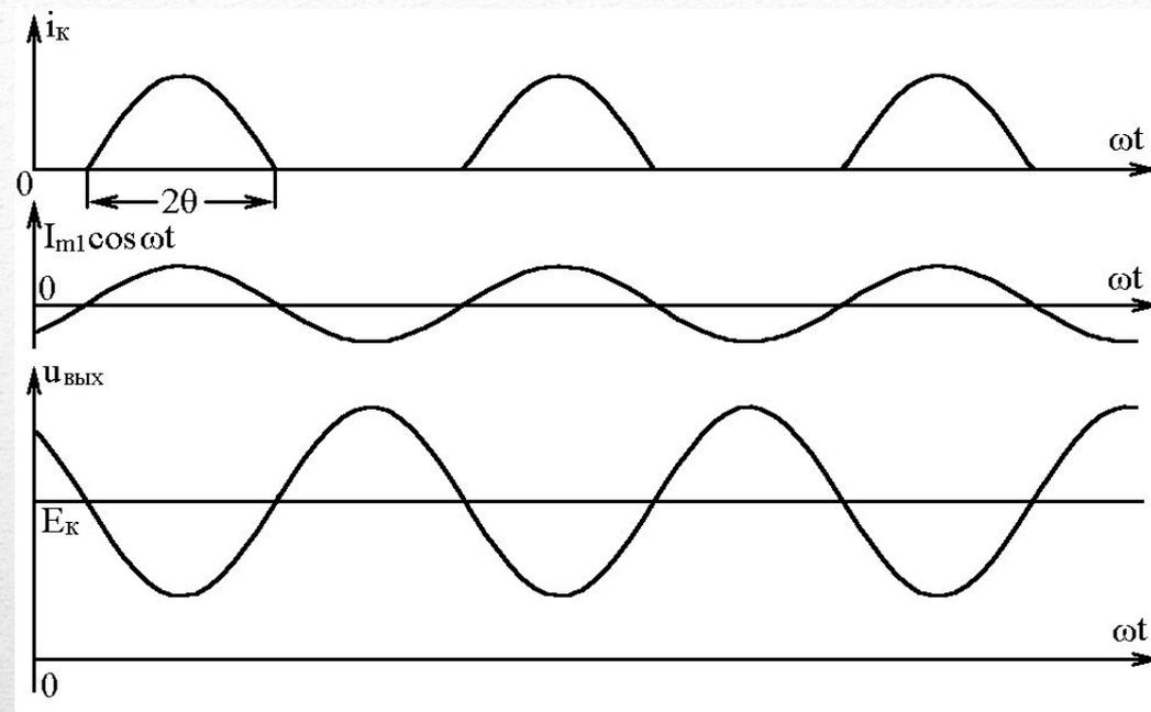
Для частоты входного сигнала настроенный в резонанс контур представляет очень большое сопротивление  $Z_{эр}$  и поэтому напряжение на контуре
