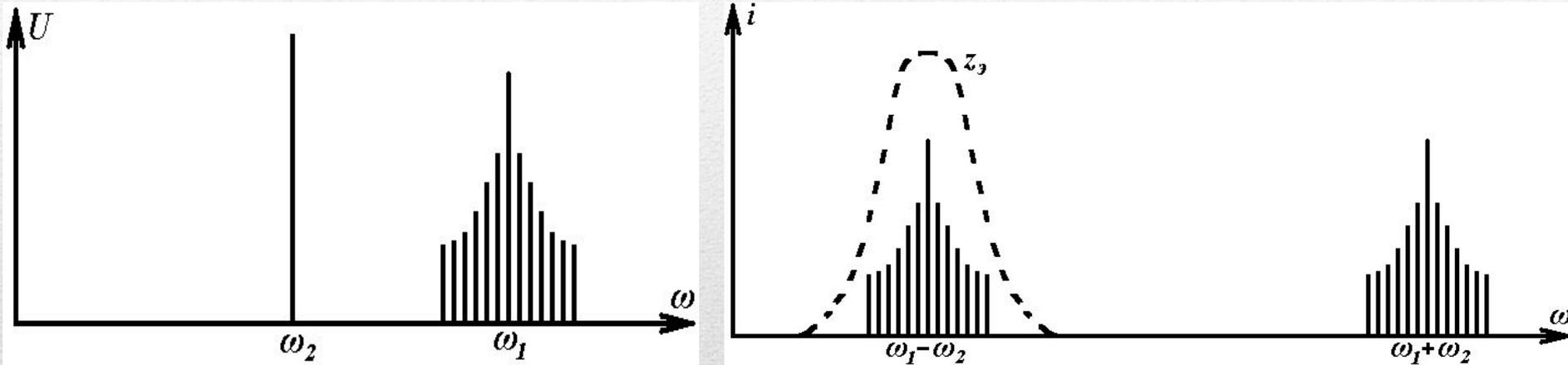
Напряжение на таком контуре будет модулированным по амплитуде по тому же закону, что и входной сигнал (8):
