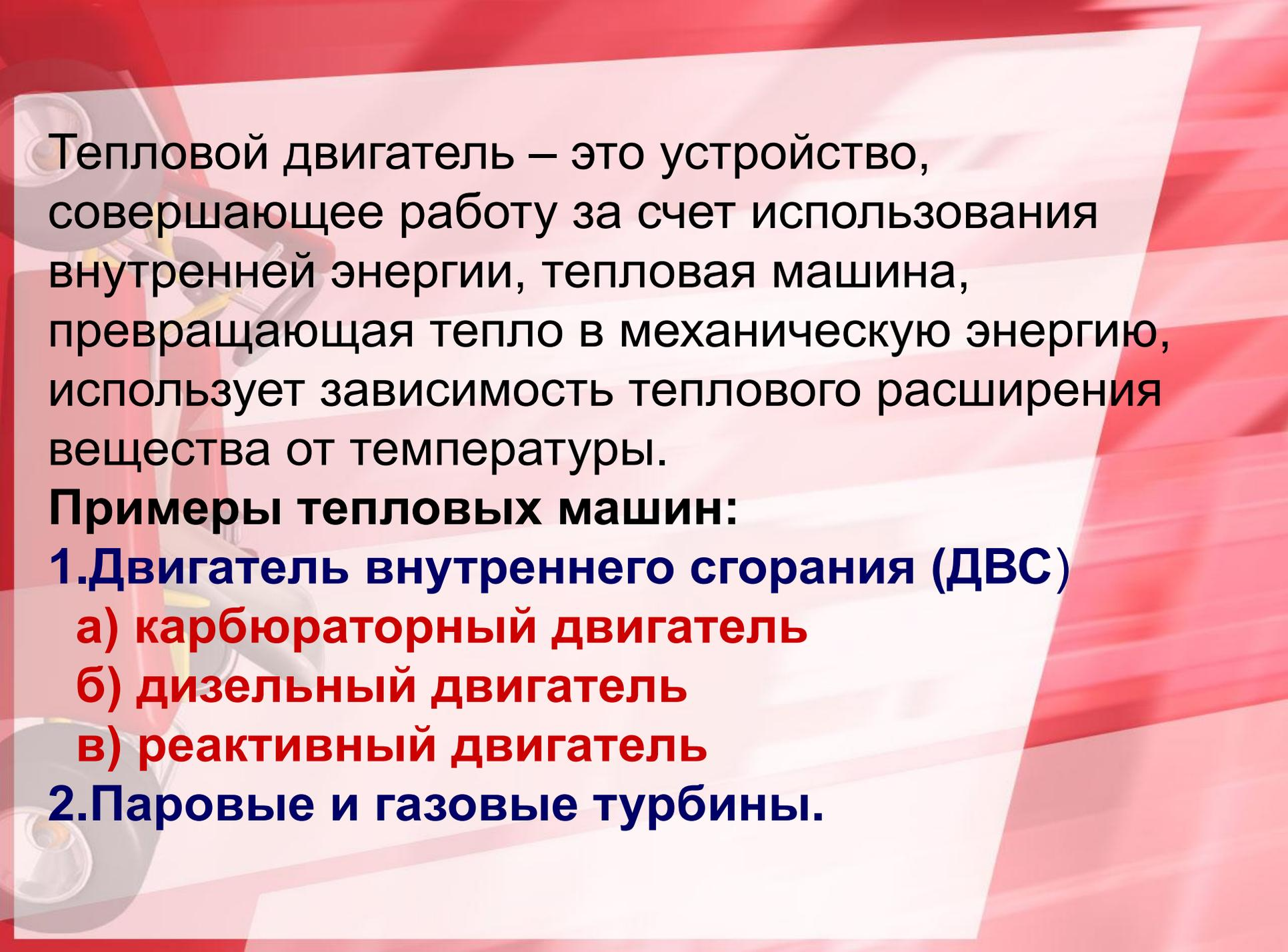
Тепловой двигатель – это устройство, совершающее работу за счет использования внутренней энергии, тепловая машина, превращающая тепло в механическую энергию, использует зависимость теплового расширения вещества от температуры.
