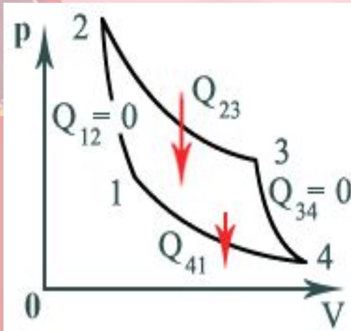
Наибольшим КПД при заданных температурах нагревателя  $T_{\text{нагр}}$  и холодильника  $T_{\text{хол}}$  обладает тепловой двигатель, где рабочее тело расширяется и сжимается по циклу Карно график которого состоит из двух изотерм (2–3 и 4–1) и двух адиабат (3–4 и 1–2).
