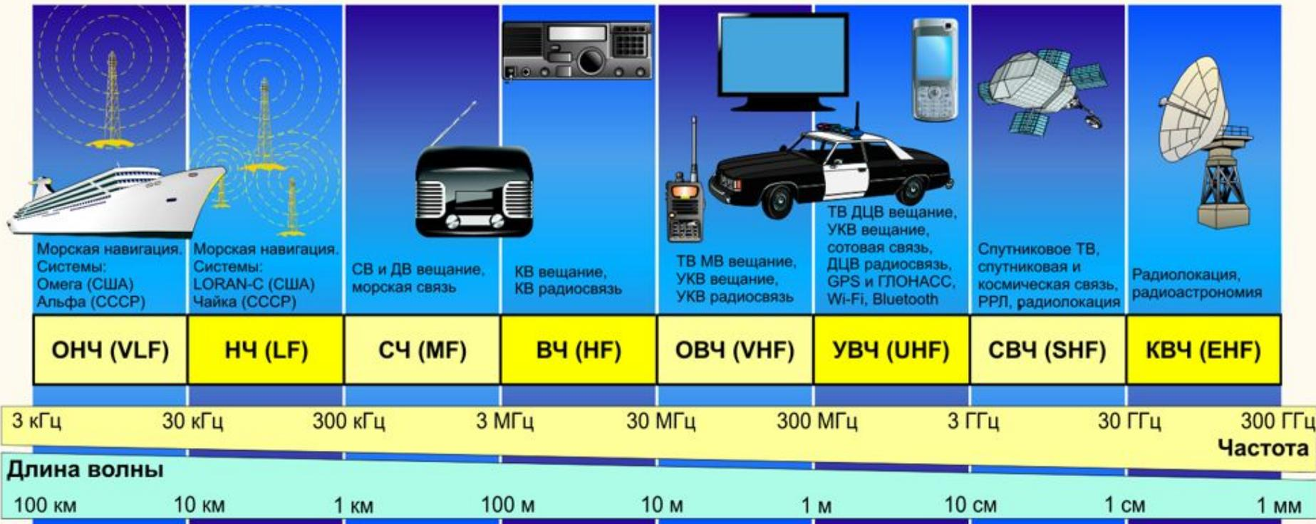
*Обычно при обозначении диапазонов выделенных для наземной подвижной связи используются следующие названия*
