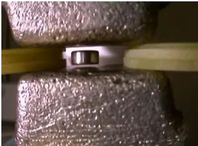
Мощный магнит из сплавов с редкоземельными металлами ( $B \sim 1$  Тл) может висеть между двумя блоками из диамagnetного висмута.
