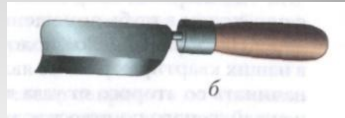
б — нож для разрезки трещин
