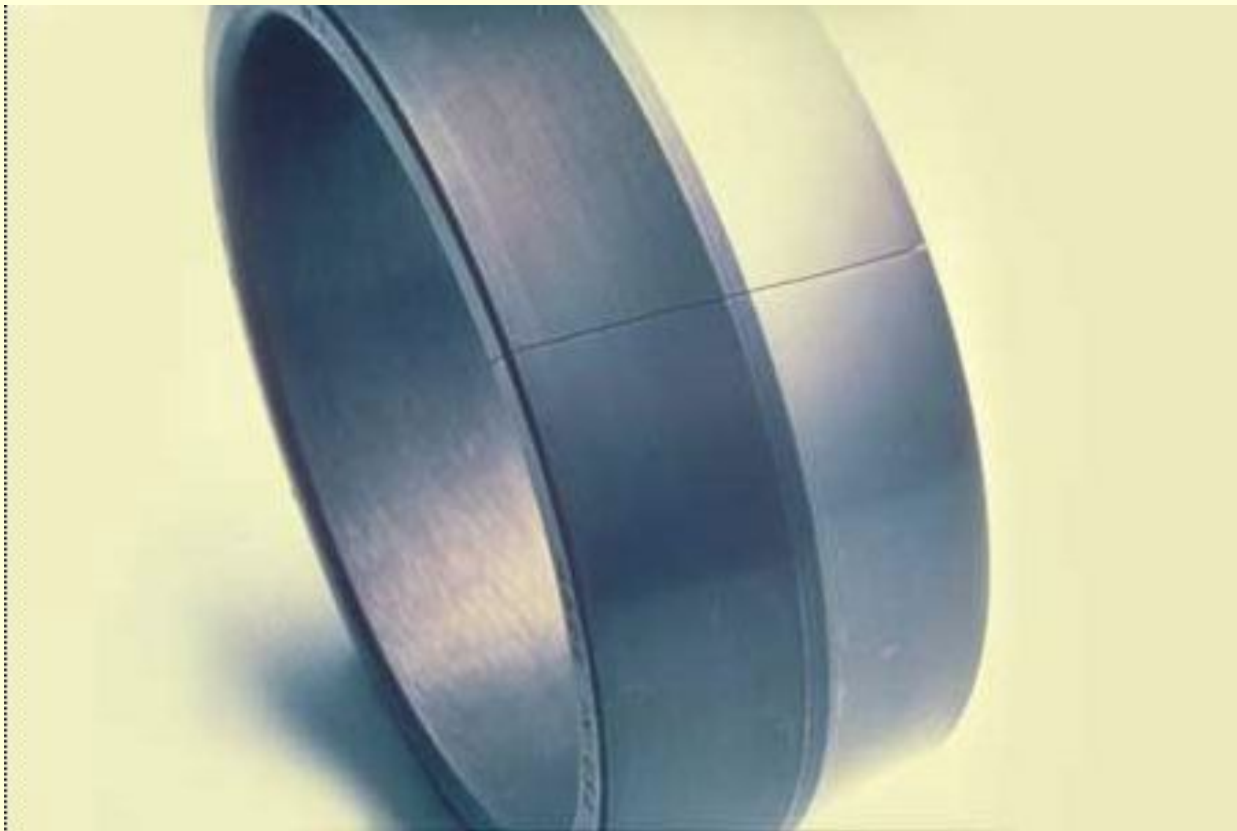
Усталостная трещина на кольце подшипника
