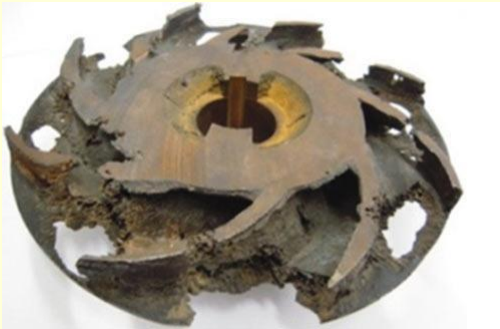
Кавитационное изнашивание гидромашин.
