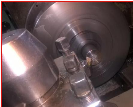
Подрезать торец заготовки на
