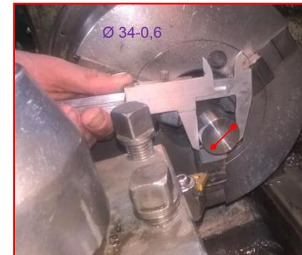
Проверить наружный диаметр  $\varnothing 34-0,6$  мм
