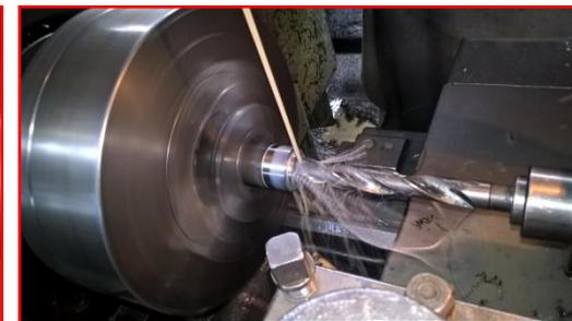
Сверлить отверстие  $\varnothing 18+0,4$  мм
