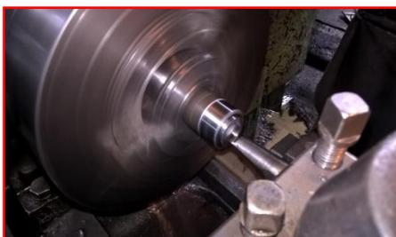
Расточить отверстие  $\varnothing 19,4 \pm 0,2$  мм на
