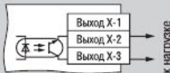
Выходной элемент типа K (транзисторная оптопара)
