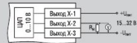
Выходной элемент типа Y (ЦАП 0...10 В)
