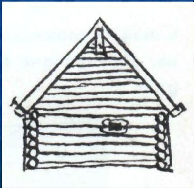
**Щипец, самец (фронтон)** — верхняя часть торцовой стены сруба, ограниченная двумя скатами кровли.
