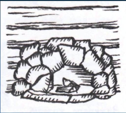
**Камелёк. камелёнок, каменка** — печь, очаг, сложенный из камней насухо, без связывающего раствора. Дым из него идет непосредственно в само помещение и вытягивается либо в дверь, либо в специальное отверстие в стене.
