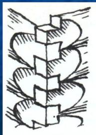
**Лапа, рубка «в лапу»** — способ соединения (рубки) бревен в углах, при котором концы бревен не выходят за пределы стены.
