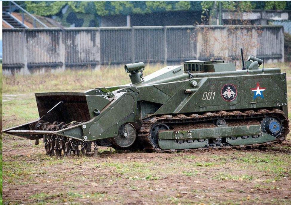
«Уран-6» представляет собой гусеничный самоходный радиоуправляемый минный трал высотой около 1,4 метра. Сравнительно малые габариты и вес «Урана» обеспечивают ему высокую мобильность. При необходимости машина, пульт управления и другие элементы комплекса могут транспортироваться любым видом транспорта, вплоть до авиации.
