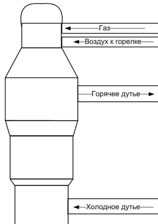
Пример упрощенного изображения объекта (воздухонагревателя) на функциональной схеме
