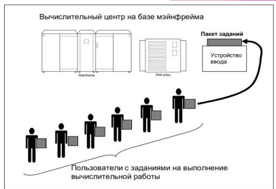
Рис. 1.2. Централизованная система на базе мэйнфрейма
