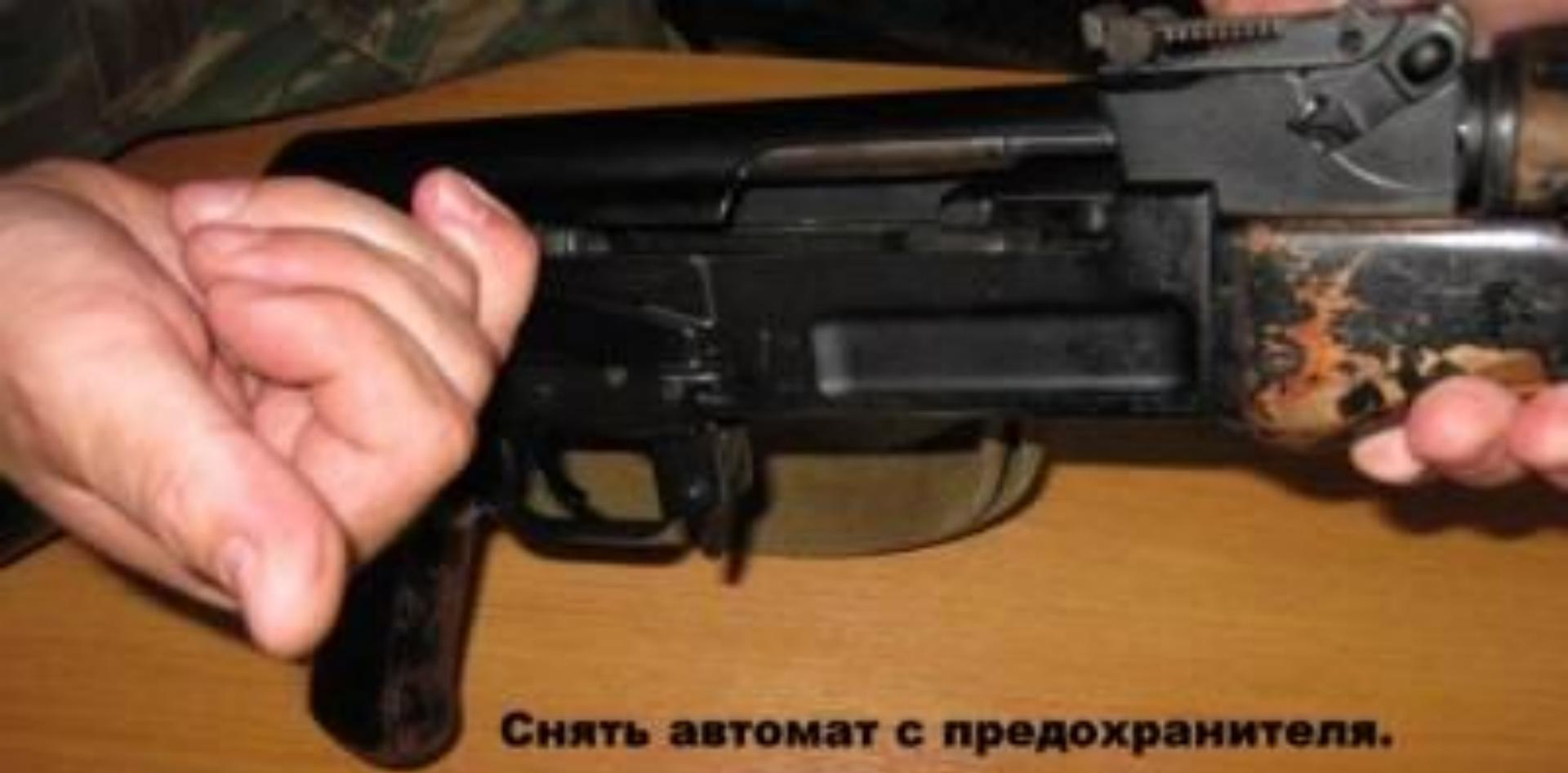
**Снять автомат с предохранителя.**
