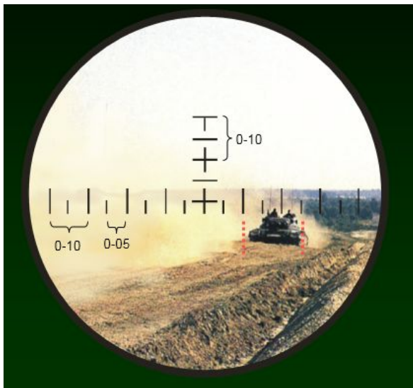
Измерение углов полевым биноклем.
