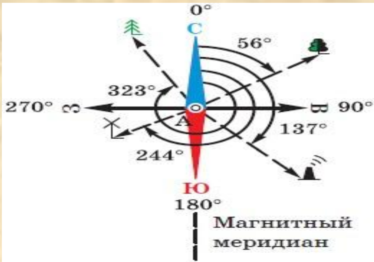
Рис. 1. Магнитные азимуты: на лиственное дерево — 56°; на фабричную трубу — 137°; на ветряную мельницу — 244°; на ель — 323°
