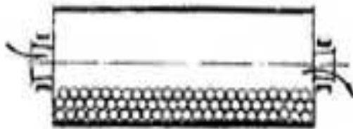
Трубная однокамерная Центральная разгрузка (через цапфу)
