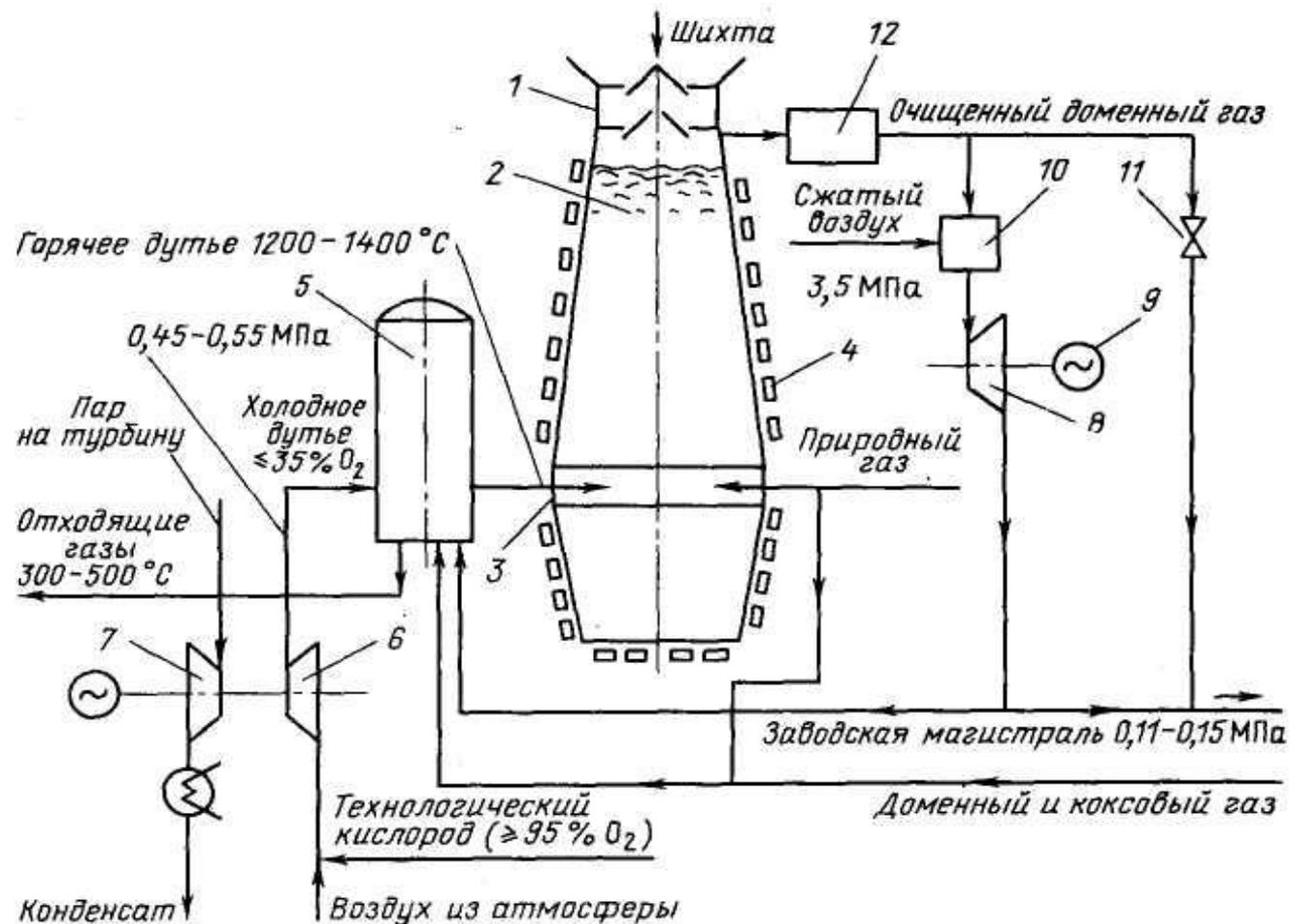
1 — загрузочное устройство; 2 — шихта; 3 — фурменная зона; 4 — холодильники; 5 — воздухонагреватели; 6 — турбокомпрессор; 7 — приводной двигатель; 8 — ГУБТ; 9 — электрогенератор; 10 — смешивающий подогреватель; 11 — редукционное устройство; 12 — газоочистка
