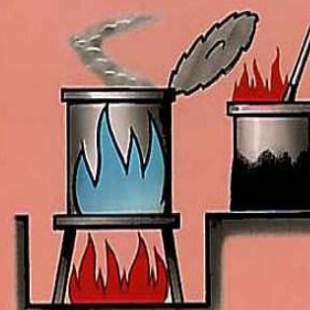
Разогревание на открытом огне лака и краски
