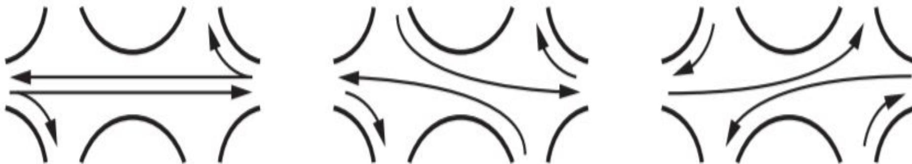
*Схема пересечения автомобильных дорог в разных уровнях типа “ромб”, устроенного в качестве первой очереди строительства пересечения типа “клеверный лист”.*
