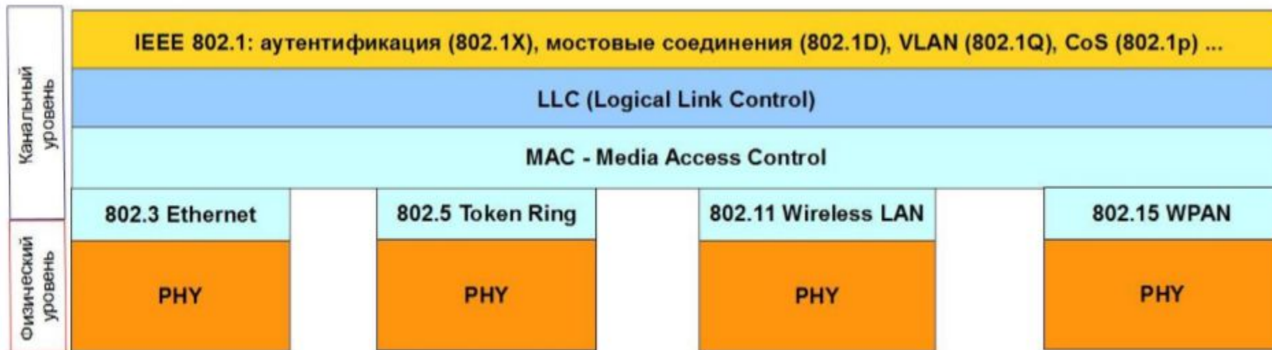
Рис. 5.4 Уровневая модель IEEE 802
