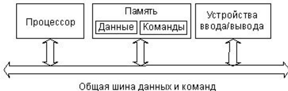
Рис. 1.4. Архитектура с общей шиной данных и команд.
