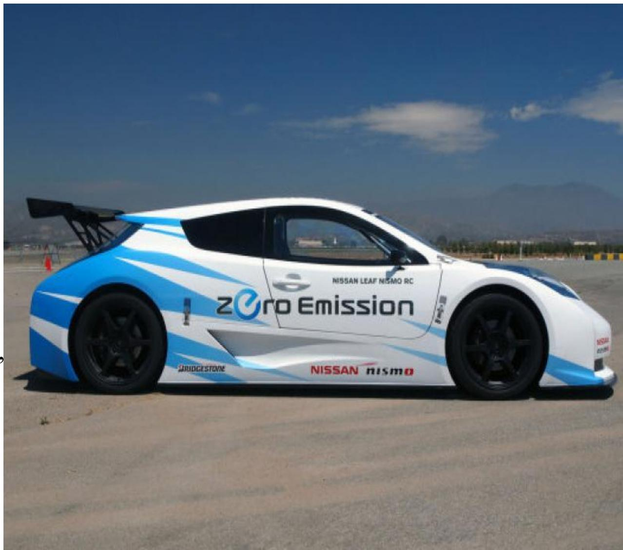
Электромобиль NISSAN LEAF, питается от 80 кВт электродвигателя-107 лошадиных сил и 254 Нм крутящего момента, что обеспечивает ускорение от нуля до 100 км в час 10,5 секунды (официальные данные)
