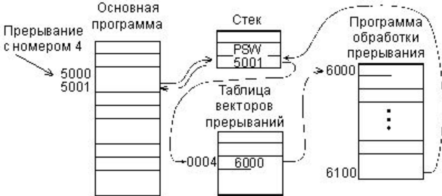
Рис. 10. Упрощенный алгоритм обработки прерывания
