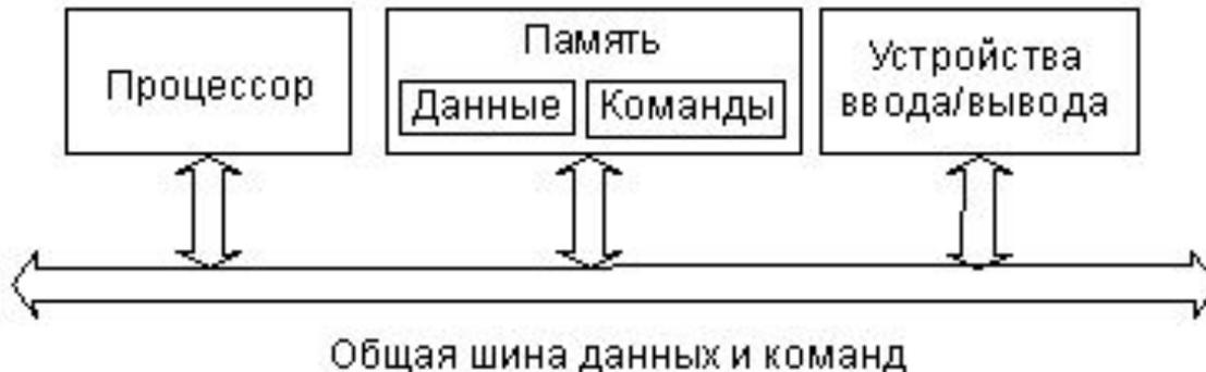
Рис. 3. Архитектура с общей шиной команд и данных
