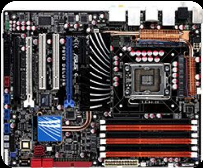
Материнская плата — это печатная плата, которая предназначена для подключения основных комплектующих компьютера. Часть из них, например, процессор или видеокарта устанавливается непосредственно на саму материнскую плату в предназначенный для этого разъем. А другая часть комплектующих, к примеру, жесткий диск или блок питания, подключается к материнской плате с помощью специальных кабелей.
