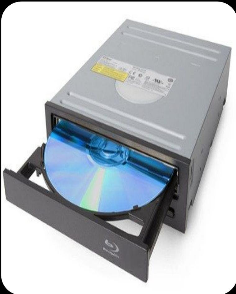
Blu-ray приводы могут быть трёх видов: считывающие, комбо и пишущие. Считывающий Blu-ray привод может считывать CD, DVD и Blu-ray диски. Комбо может дополнительно записывать CD и DVD-диски. Пишущий Blu-ray привод может считывать и записывать все диски.
