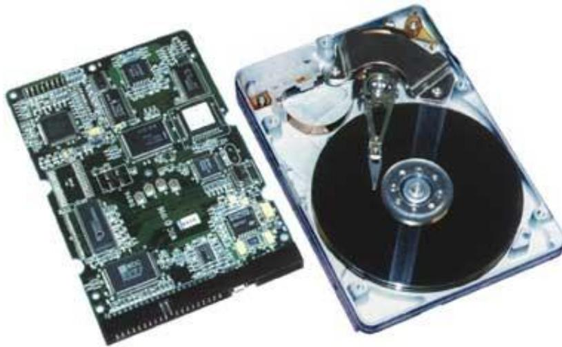
В одном корпусе объединены дисковод (устройство для записи/чтения информации с дисков) и непосредственно сами диски
