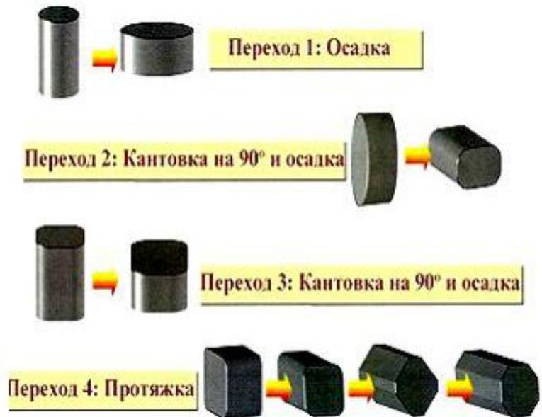
Такая схема деформации позволяет сохранить форму и размеры заготовки, обеспечив ее интенсивную горячую деформацию, которая обычно сопровождается рекристаллизацией.
