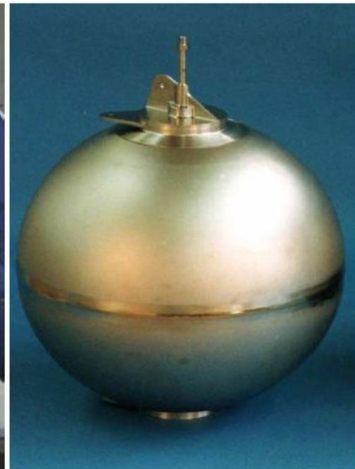
Изготовление методом сверхпластической формовки топливных баков из титанового сплава Ti-6Al-4V для спутников и ракет на фирме FormTech (Германия)
