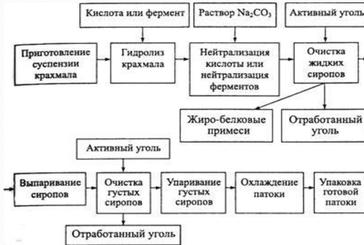
Блок-схема производства крахмальной патоки
