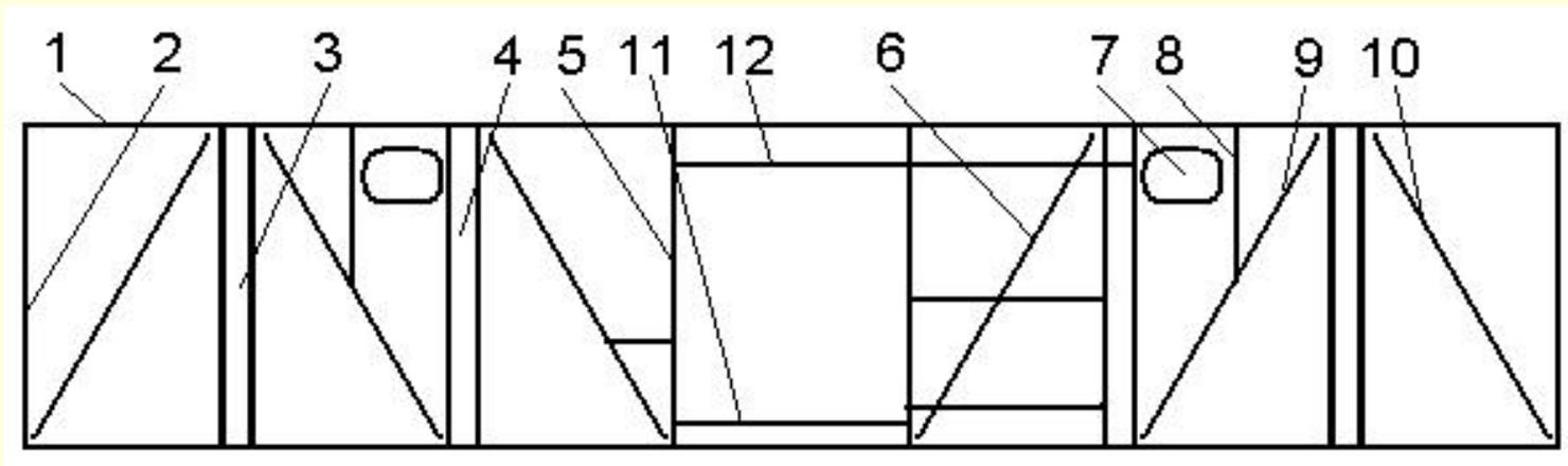
1-верхняя обвязка, 2-угловая стойка, 3-шкворневая стойка, 4- промежуточная стойка, 5- дверная стойка, 6-дверной раскос, 7-боковой люк, 8-угольник люкового проема, 9-шкворневой раскос, 10-концевой раскос, 11-порог, 12-дверной рельс
