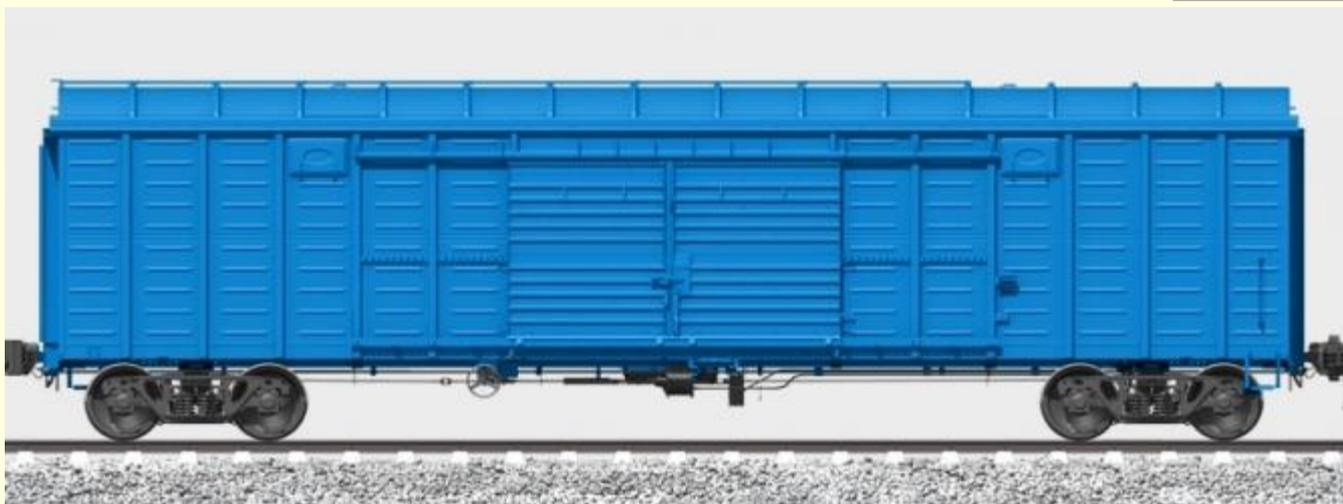
**Вагон крытый модели 11-280** предназначен для транспортировки тарно-штучных, пакетированных и некоторых видов сыпучих грузов, требующих защиты от атмосферных осадков. Крыша вагона съемная, это облегчает ремонт вагона при ее замене. Изготовление люков в крыше вагона осуществляется по требованию заказчика.
