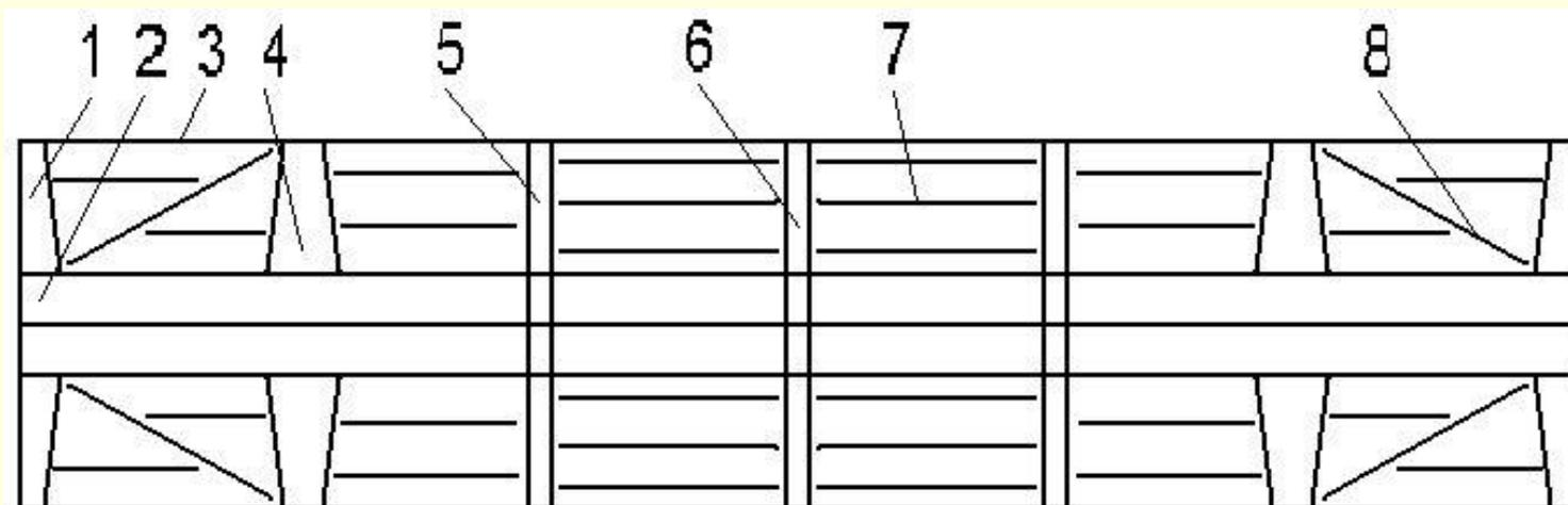
1-концевая балка, 2-хребтовая балка, 3-боковая балка,
