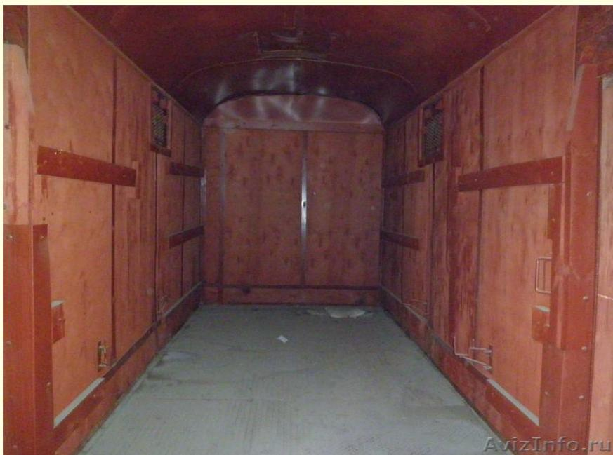
Внутри кузовов крытого вагона обшит фанерой для защиты груза от конденсата на металлической обшивке при перепаде температуры.
