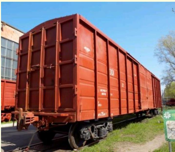
Вагон предназначен для транспортировки по сети железных дорог Украины, стран СНГ и Балтии штучных, тарно-штучных и пакетированных грузов, требующих защиты от атмосферных осадков, а также автомобилей в один ярус.
