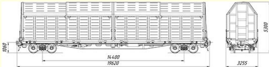
Вагон предназначен для перевозки бумаги в рулонах, пакетированных легковесных пиломатериалов, штабельных, штучных, тарно-штучных, грузов на поддонах и других грузов, требующих защиты от атмосферных осадков.
