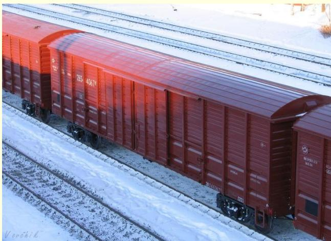
Цельнометаллический 4-осный крытый вагон с уширенным дверным проемом для железнодорожных грузоперевозок штучных, тарно-штучных и пакетированных грузов широкой номенклатуры, требующих защиты от атмосферных осадков.
