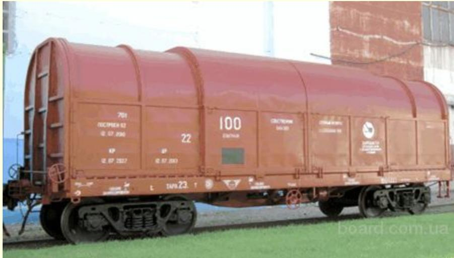
Вагон предназначен для перевозки стального листового проката в рулонах диаметром от 950 до 2050 мм, с шириной полосы от 900 до 1800 мм и массой рулона от 5 до 24 т, требующего защиты от атмосферных осадков.
