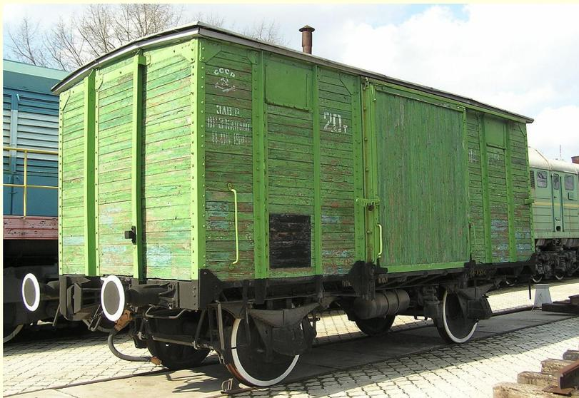
**Теплу́шка** — вагон, созданный на основе крытого товарного вагона и предназначенный для перевозки людей и животных. Название появилось в 1870-х годах как сокращение от «утеплённый вагон» и часто используется до сих пор. Созданный в 1875 г.
