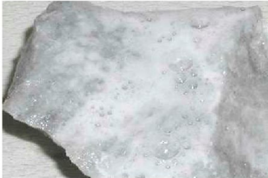
Реакция кальцита с разбавленной соляной кислотой
