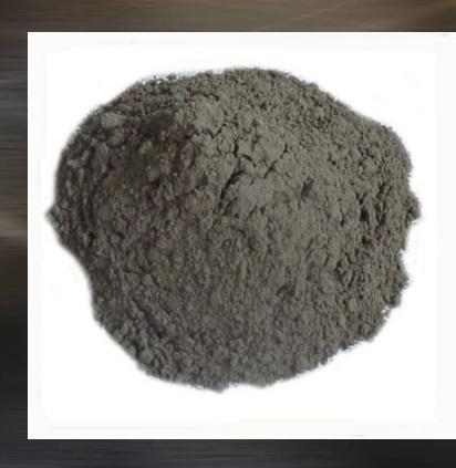
П. — наиболее распространённый в современном строительстве вид цемента. Получают П. тонким измельчением клинкера с гипсом (3-7%); допускается введение в смесь активных минеральных добавок (10-15%).
