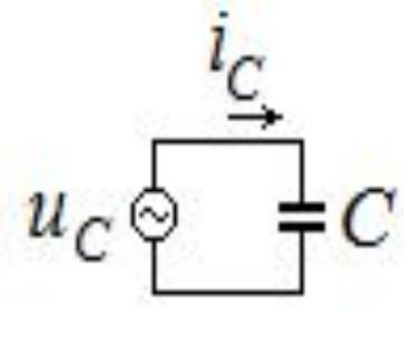
Изучая прохождение переменного тока через конденсатор под действием переменного напряжения  $u_C$ , мы выяснили, что амплитуда тока выражается формулой  $I_{mc} = U_{mc} * \omega C$ , а фаза тока превышает фазу напряжения на  $\pi/2$ .
