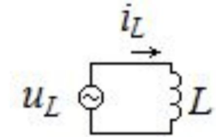
Амплитуда тока в катушке вновь связана с амплитудой напряжения на ней формулой внешне похожей на закон Ома  $I_{mL} = U_{mL} / \omega L$ . Величину  $X_L = \omega L$  называют сопротивлением катушки индуктивности переменному току. Поскольку  $\sin(\omega t) = \cos(\omega t - \pi/2)$ , фаза тока в катушке будет на  $\pi/2$  меньше, чем фаза напряжения на ней
