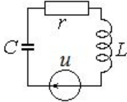
Рассмотрим такое суммирование на примере анализа цепи переменного тока, представляющей собой последовательный колебательный контур.
