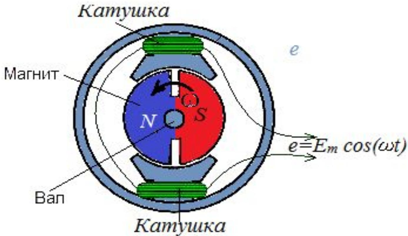
Генератор переменной ЭДС представляет собой катушку, которая находится в поле вращающегося постоянного магнита. Для доставки магнитного потока в катушку используется ферромагнитный магнитопровод.
