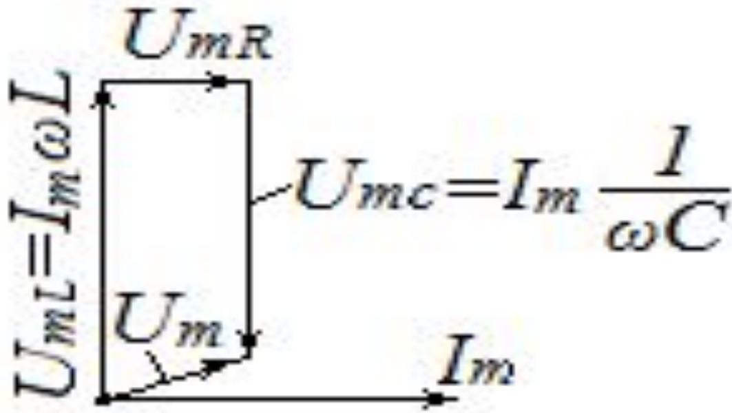
Для катушки индуктивности вектор колебаний напряжения повернут на  $+\pi/2$  по отношению к вектору тока, для конденсатора - на  $-\pi/2$ , а для резистора векторы колебаний тока и напряжения совпадают по направлению. Сума векторов напряжений на L, R, C даст нам вектор напряжения источника -  $u$ .
