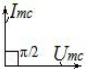
Изобразим колебания напряжения и тока на векторной диаграмме, где вектор тока повернут относительно вектора напряжения в положительную сторону на  $\pi/2$
