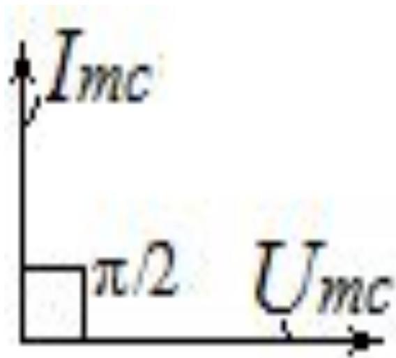
При построении диаграмм первый вектор строится произвольно, остальные векторы относительно его достраиваются однозначно. Построим вектор  $u_C$  горизонтально. Вектор  $i_C$  должен быть повернут относительно вектора  $u_C$  на  $\pi/2$  в положительном направлении. На диаграмме векторы обозначены как амплитуды величин, которые они изображают.
