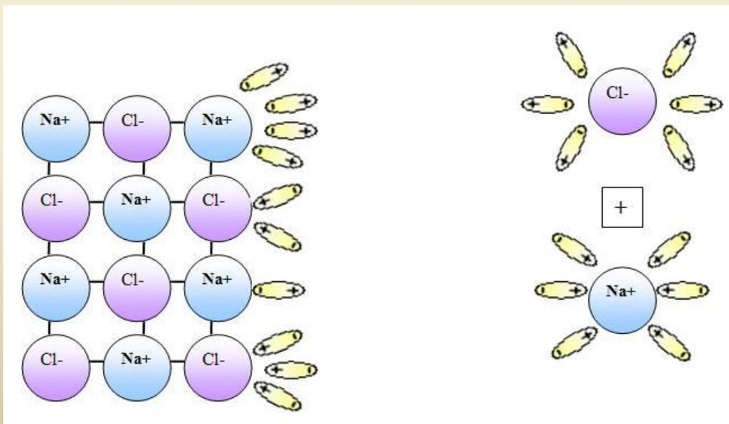
Ионные растворы достаточно устойчивы к расслоению, а также способны проводить электрический ток (являются проводниками электрического тока II рода)
