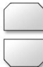
Символ из двух частей – начала и конца цикла. Операции, выполняемые внутри цикла, размещаются между ними. Условия цикла и приращения записываются внутри символа начала или конца цикла в зависимости от типа цикла.
