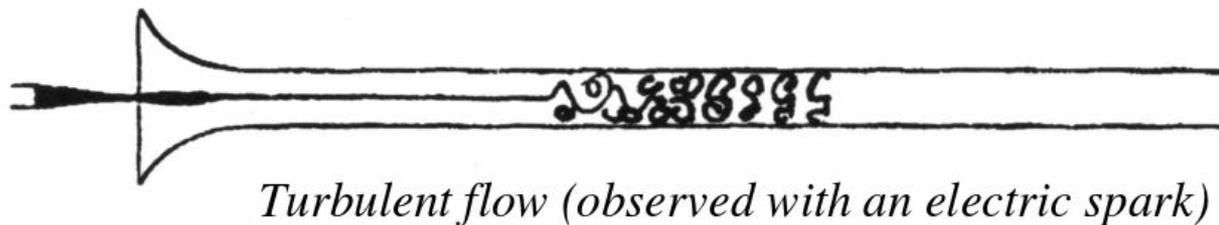
Рассмотрим течение жидкости в длинной *круглой* трубе постоянного диаметра, так что свойства течения не зависят от координаты вдоль трубы (например скорость).
