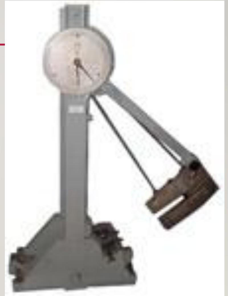
Зная работу  $A_H$ , Дж, затраченную маятником на разрушение образца (с надрезом), и площадь поперечного сечения образца в месте надреза  $F_H$ , м<sup>2</sup>, определяют ударную вязкость образца (с надрезом)  $a_H$ , Дж/м<sup>2</sup>:
