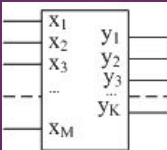
Схема, приведенная на рисунке 1, показывает, что на вход подается  $M$  сигналов, а на выходе из них формируется  $K$  выходных сигналов. При этом во внутренней схеме не должно быть обратных связей, как это показано на рисунке 2.
