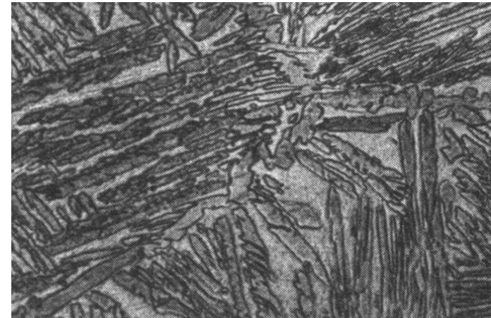
Микроструктура титанового сплава ВТ6 после закалки ( \times 400 )
