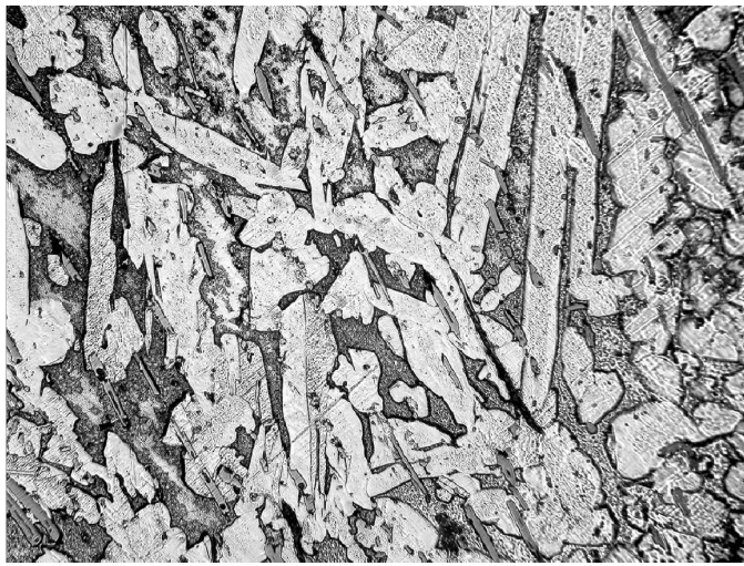
Микроструктура двухфазной латуни ЛМцСКА
