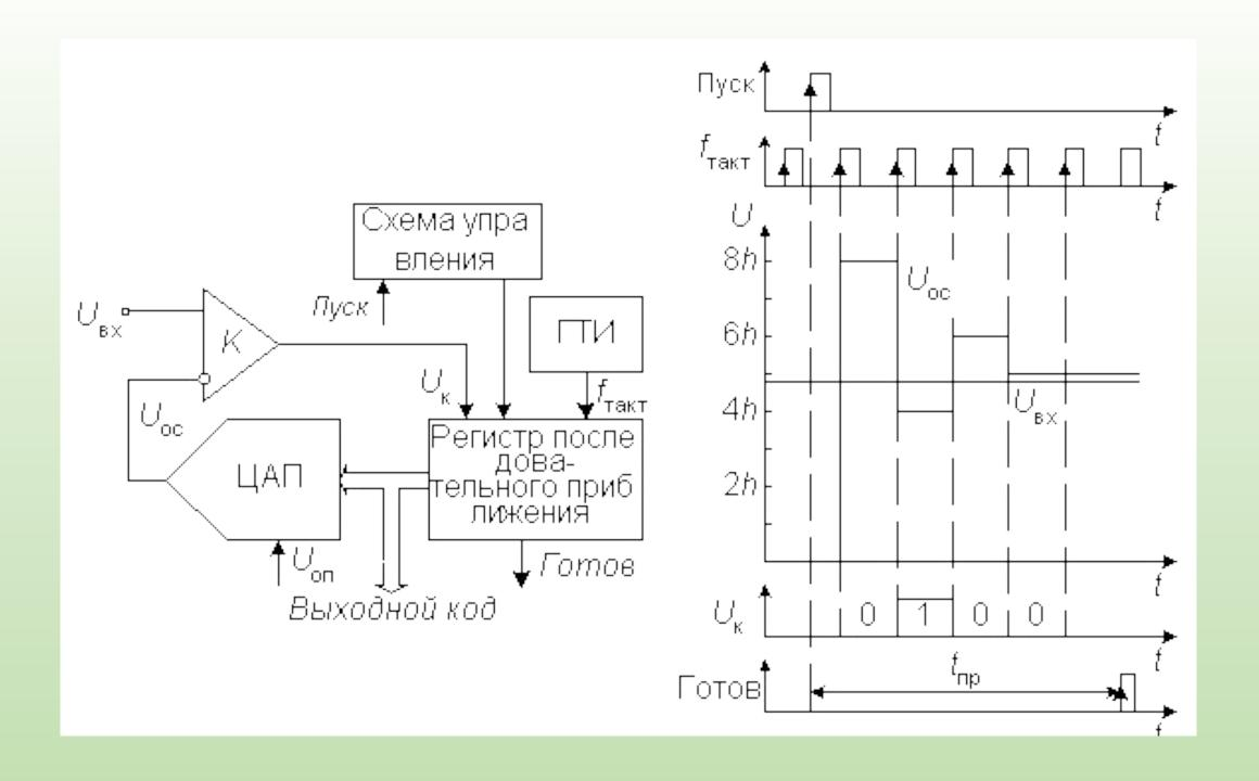
После подачи команды "Пуск" с приходом первого тактового импульса РПП принудительно задает на вход ЦАП код, равный половине его шкалы.
