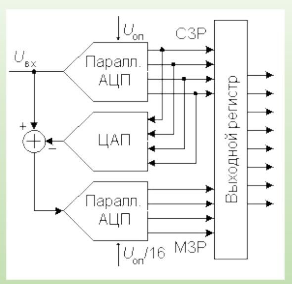
Верхний по схеме АЦП осуществляет грубое преобразование сигнала в четыре старших разряда выходного кода. Цифровые сигналы с выхода АЦП поступают на выходной регистр и одновременно на вход 4-разрядного быстродействующего ЦАП.
