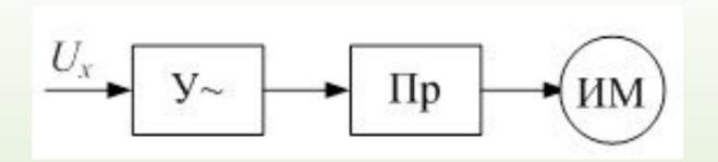
Благодаря предварительному усилению удается повысить чувствительность. Однако создание усилителей переменного тока с большим коэффициентом усиления, работающих в широком диапазоне частот — достаточно трудная техническая задача.
