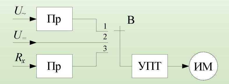
В зависимости от положения переключателя В вольтметр работает по схеме вольтметра переменного тока с преобразователем П (положение 1) или вольтметра постоянного тока (положение 2).
