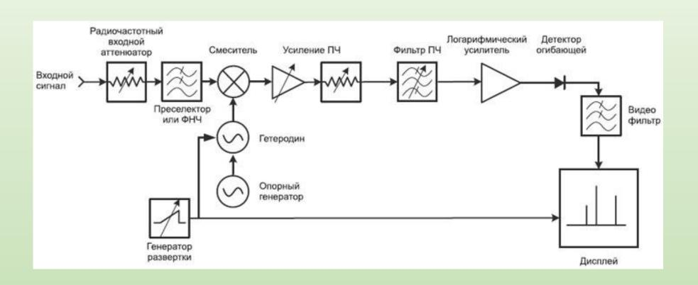
Анализируемое напряжение  $u_x$  поступает на смеситель См, на который подается сигнал от генератора Г. На выходе смесителя См образуется сигнал, имеющий частоту, равную разности частот неизвестного сигнала  $u_x$  и сигнала гетеродина. Сигнал с выхода смесителя поступает на фильтр  $\Phi$ .
