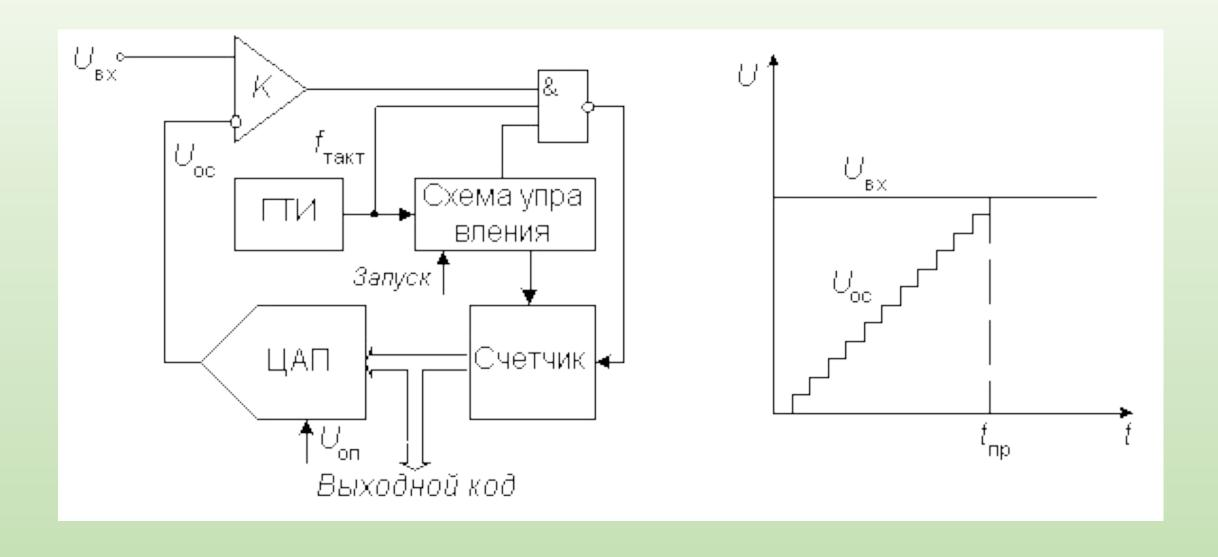
Работа преобразователя начинается с прихода импульса запуска, который включает счетчик, суммирующий число импульсов, поступающих от генератора тактовых импульсов ГТИ.
