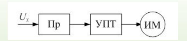
В вольтметрах по схеме, измеряемое напряжение сначала преобразуется в постоянное напряжение, которое затем подается на УПТ и ИМ, являющиеся, по существу, вольтметром постоянного тока.
