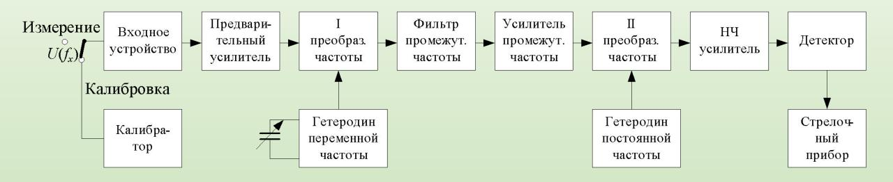
В трактах многоканальной связи при наличии контрольных частот измерения возможны только избирательными приборами.
