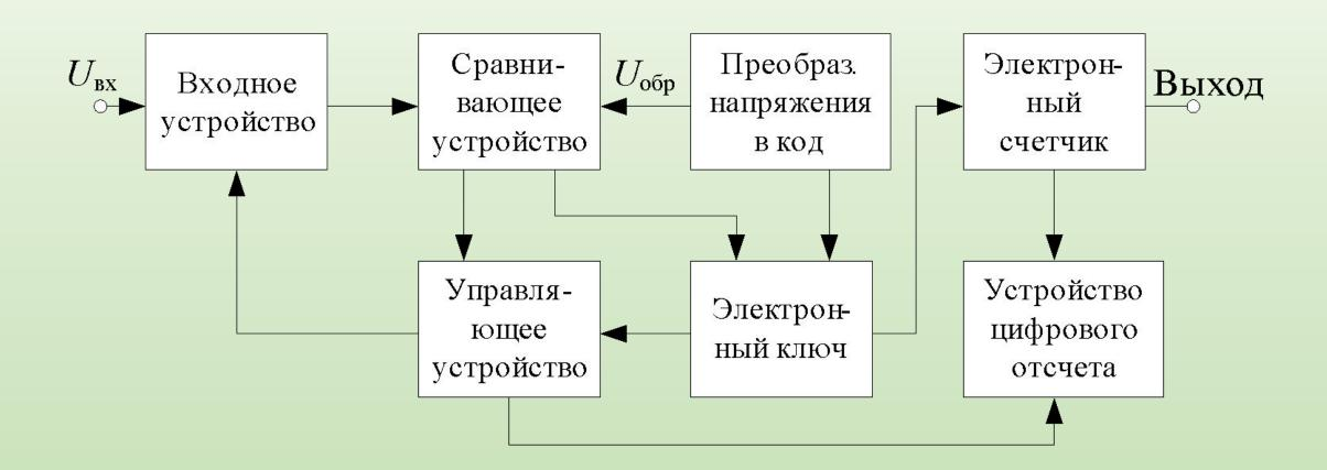
Входное устройство при измерении постоянных или медленно меняющихся напряжений представляет собой высокоомное сопротивление (10 МОм) или катодный (эмиттерный) повторитель с калиброванным делителем, а при измерении высокочастотных напряжений — частотнокомпенсированный делитель, катодный повторитель и детекторный преобразователь.
