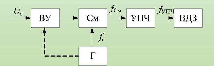
Измеряемый сигнал  $u_x$  через избирательный входной усилитель ВУ подается на смеситель См, предназначенный для преобразования частотного спектра измеряемого сигнала. На выходе смесителя появляется сигнал, пропорциональный измеряемому сигналу, но с частотами спектра
