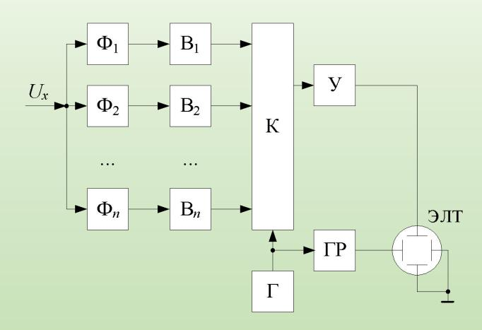
Исследуемый сигнал напряжением  $u_x$  одновременно поступает на фильтры  $\Phi_1 - \Phi_n$ , настроенные на различные частоты. Сигналы с фильтров через выпрямители  $B_1 - B_n$ , коммутатор K, усилитель Y поступают на пластины вертикального отклонения ЭЛТ.
