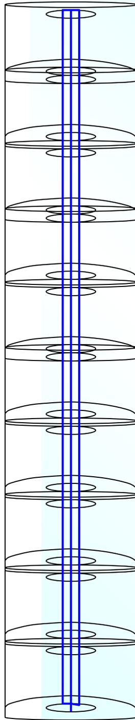
Оригинальная идея для строительства башни была найдена архитекторами Л. Баталовым и Д. Бурдиным при участии конструктора Н. Никитина. Внутри цилиндрических бетонных блоков натянута металлические тросы. Такая конструкция необычайно устойчива.
