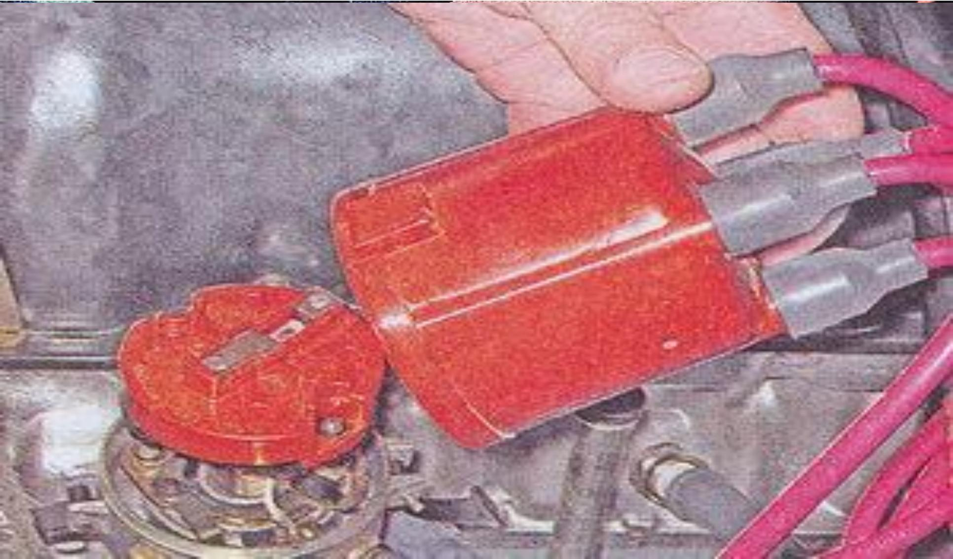
Приходит ток высокого напряжения по проводу высокого напряжения с катушки зажигания на центральный контакт крышки, с него ток идет на ротор, с ротора на боковые контакты, при вращении вала, с них по проводам высокого напряжения на свечи в цилиндрах ДВС, согласно порядку работы цилиндров
