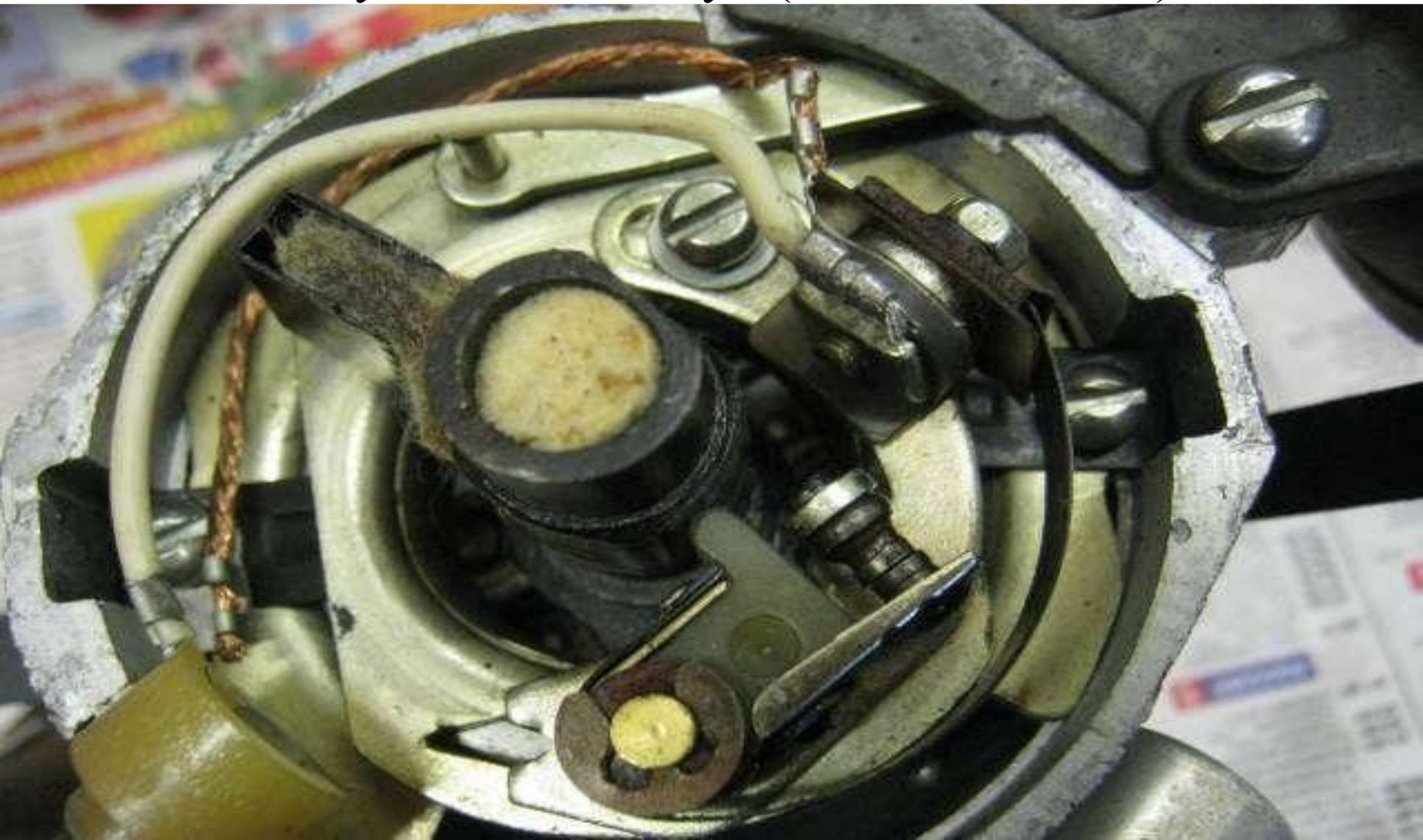
Когда «ребро» давит на рычаг контакты открываются, связь с массой теряется и напряжение в «цепи» «падает до «0». Зачем это сделано? Зачем сделали падение напряжения с 12V до 0V?
