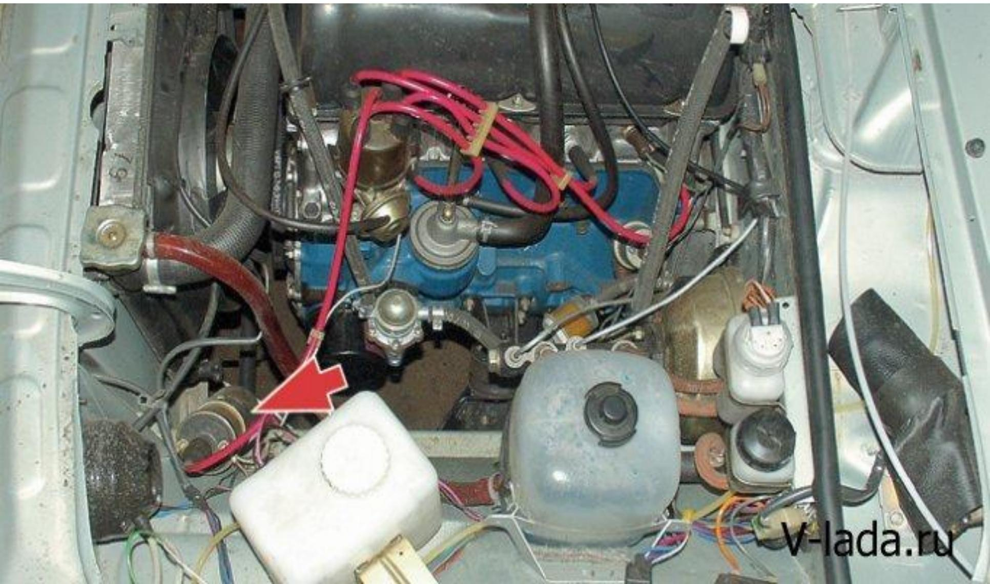
Со вторичной обмотки катушки зажигания ток идет по высоковольтному проводу на центральный контакт крышки прерывателя-распределителя?
