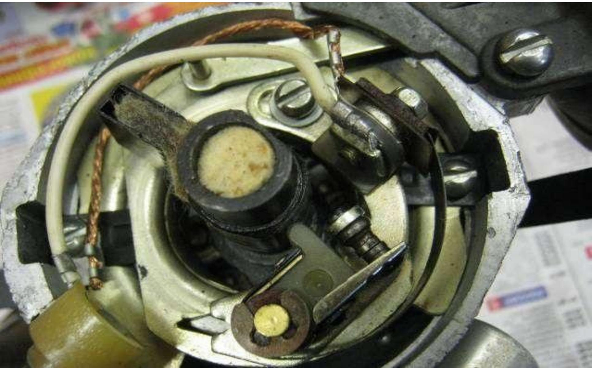
С катушки ток приходит на клемму 6, с нее ток идет по проводу на клемму 4 и по корпусу контактов на подвижный контакт 4, когда «ребро» кулачкового вала не давит на рычаг
