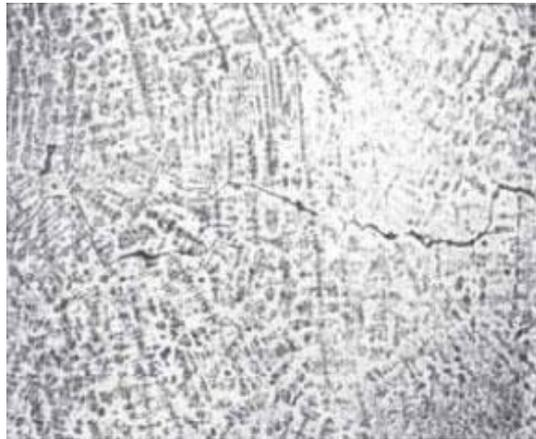
**Межкристаллическая трещина** - дефект в виде разрыва тела отливки. Возникает при охлаждении отливки в форме на границах первичных зерен аустенита в температурном интервале распада.
