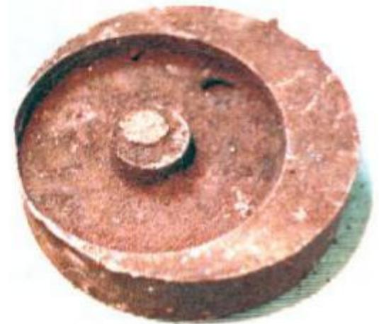
Перекас: а - схема, б - дефектные отливки
