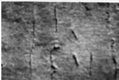
**Просечка** - дефект в виде невысоких прожилок на поверхности отливки, возникших вследствие затекания металла в трещины на поверхности формы или стержня.
