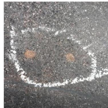
**Шлаковая раковина (залитый шлак)** – полость, частично или полностью заполненная шлаком.
