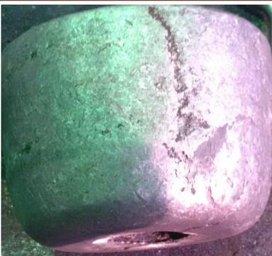
**Утяжина** - дефект в виде углубления с закругленными краями на поверхности отливки, образовавшегося вследствие усадки металла при затвердевании.
