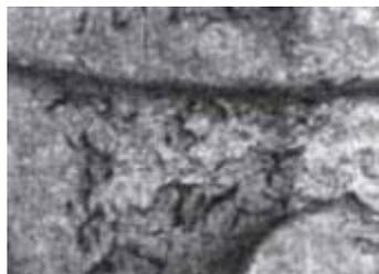
**Складчатость** – дефект в виде незначительных гладких возвышений и углублений на поверхности отливки, возникающих вследствие пониженной жидкотекучести металла. Основные причины: тепловые деформации поверхностного слоя формы или затвердевающего металла, пониженная жидкотекучесть металла.
