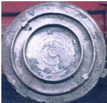
**Пригар** - специфический трудноотделяемый слой на поверхности отливки, возникший при взаимодействии расплавленного металла с материалом формы. Этот дефект образуется преимущественно на поверхности отливок из сплавов с высокой температурой плавления и при заливке в песчаные формы.
