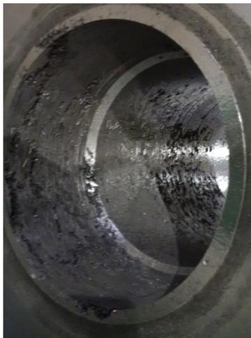
**Усадочная пористость** – дефект в виде мелких пор, образовавшихся вследствие усадки металла во время его затвердевания при недостаточном питании отливки.
